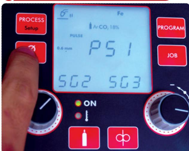
No sólo permite ajustar todos los parámetros de una forma cómoda sino que también **permite grabar un determinado proceso con sus correspondientes valores** para repetirlo cuantas veces se quiera y no haya ninguna variación en dicho proceso.
